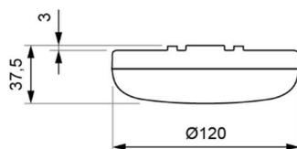
Montaje empotrado hueco (corte: Ø 130 mm)
